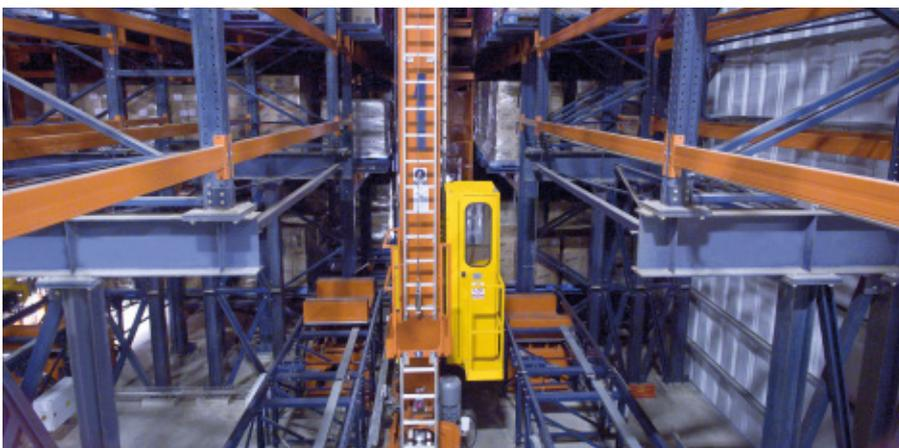
Al trabajar con palets de tipo perimetral (poseen patines con entradas por los cuatro lados), se han colocado travesaños perpendiculares a los largueros de las estanterías para apoyar el palet y, de este modo, garantizar que los transelevadores los manipulen con la máxima seguridad. Este tipo de palets ayudan a mejorar la estabilidad a la hora de remontarlos.
