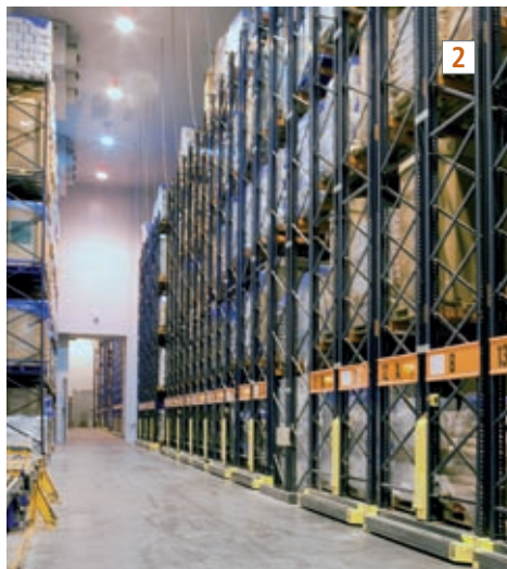
En los racks sobre bases móviles se depositan los pedidos de media rotación o con pallets de medidas variables.
