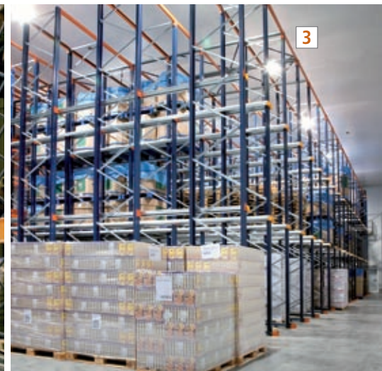
Los racks penetrables permiten almacenar productos monorreferencia y que permanecerán largo tiempo almacenados.
