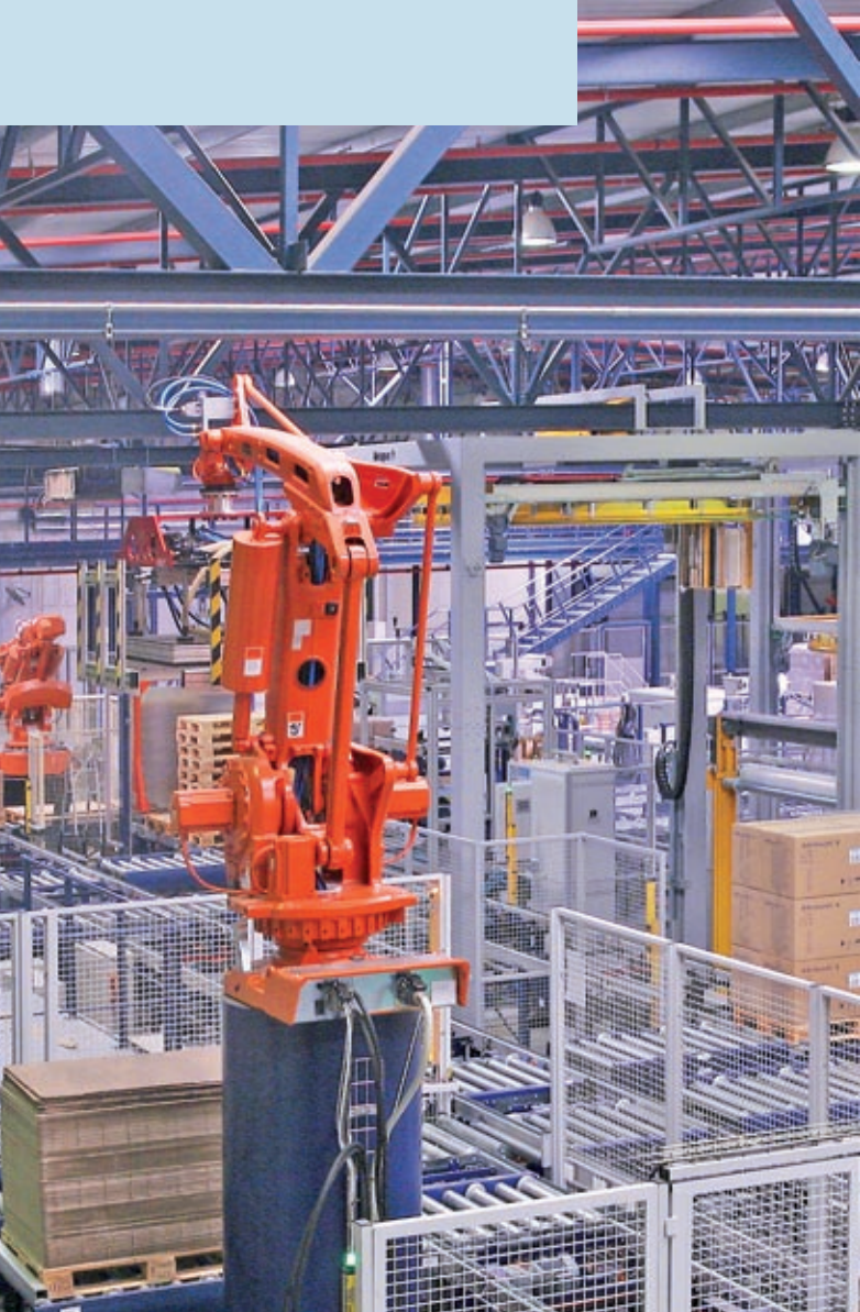
Esquema del funcionamiento del sistema con picking automático y robot despaletizador.
