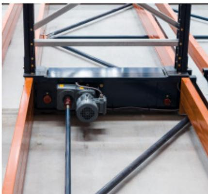
La transmisión de la potencia a las bases móviles se efectúa a través de un engranaje con doble corona y doble piñón, que confiere un mejor comportamiento del sistema. De este modo, se garantiza que el movimiento de la estantería sea más uniforme y, como consecuencia, se alarga la vida de los elementos mecánicos.
