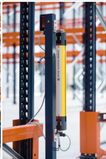
Las estanterías Movirack incorporan dispositivos de seguridad, como barreras externas e internas con fotocélulas, que detienen toda actividad cuando los operarios trabajan en el interior del pasillo
