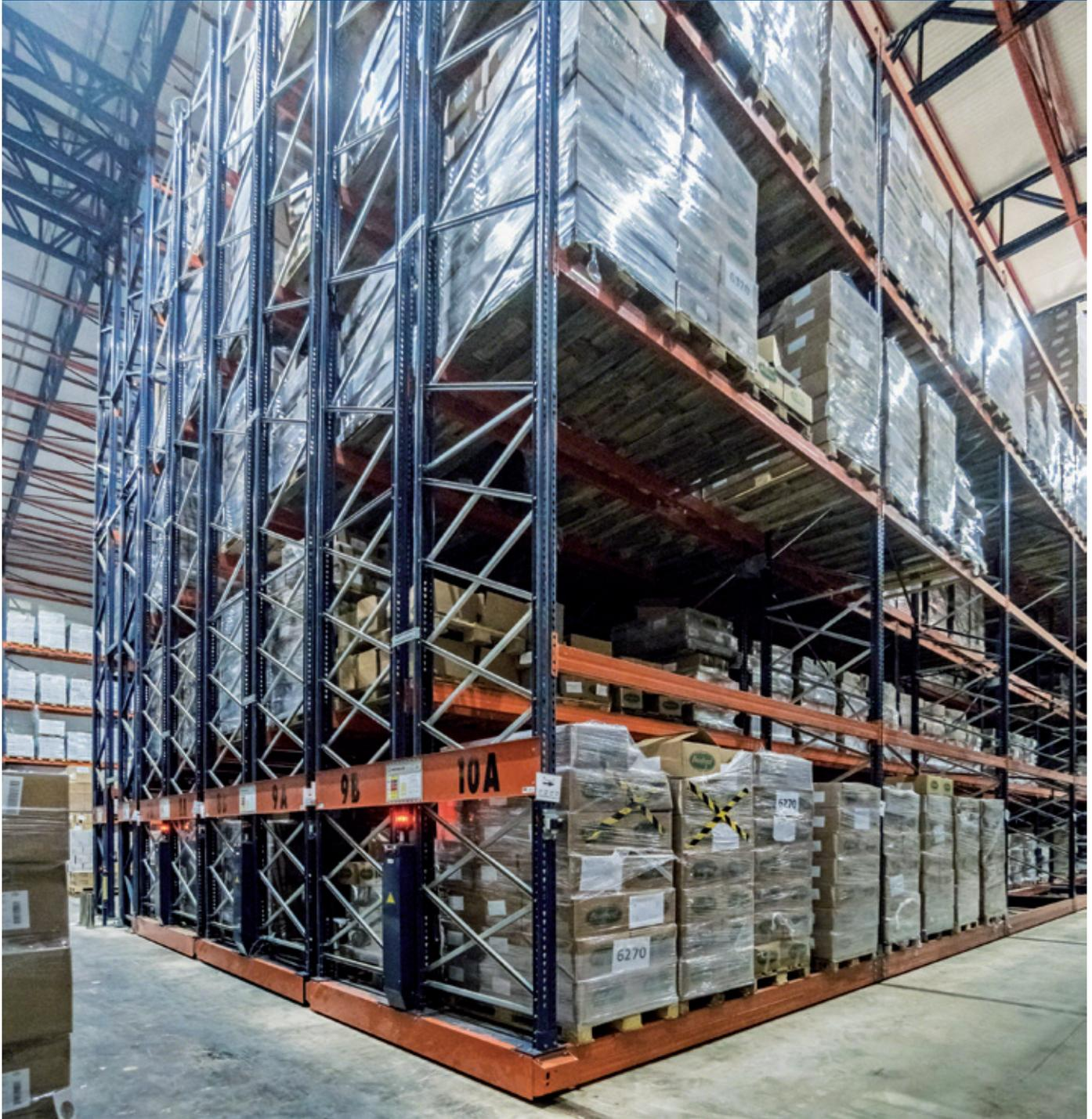
Mecalux ha construido un almacén autoportante y lo ha equipado con estanterías sobre bases móviles Movirack destinadas a almacenar los productos congelados de la fábrica de alimentación de Benfood. Con esta solución, pensada para almacenar 2.600 palets en una primera fase, la compañía aumenta la capacidad almacenaje y reduce los costes logísticos.
