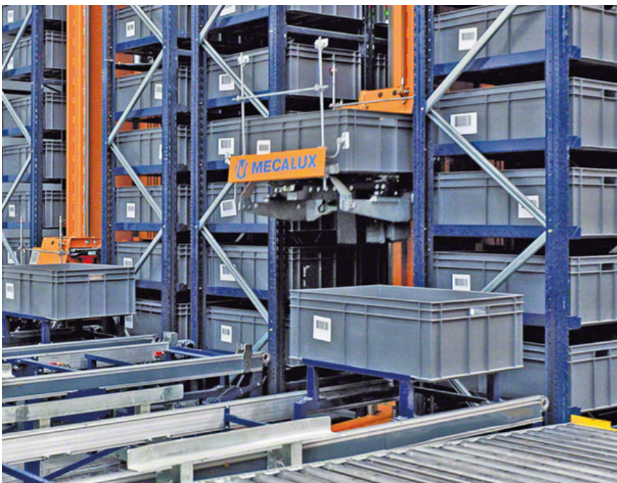
Gama ligera ML50 (Es capaz de manipular una caja de hasta 50 kg a una altura de 10 m).
