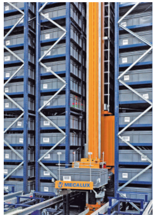
Gama alta MLB (Puede superar los 20 m y transportar cuatro cajas de 50 kg).
