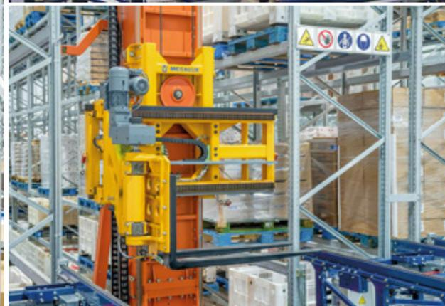
El transelevador trilateral automático, guiado por dos carriles, solo tiene cuatro puntos de apoyo sobre el suelo. No lleva testero superior, lo que facilita que pueda ser instalado en cualquier bodega donde habitualmente se utilicen grúas. Además, se adapta a casi todos los espacios de acceso directo a estibas y no precisa de suelo especial de alta planimetría.
