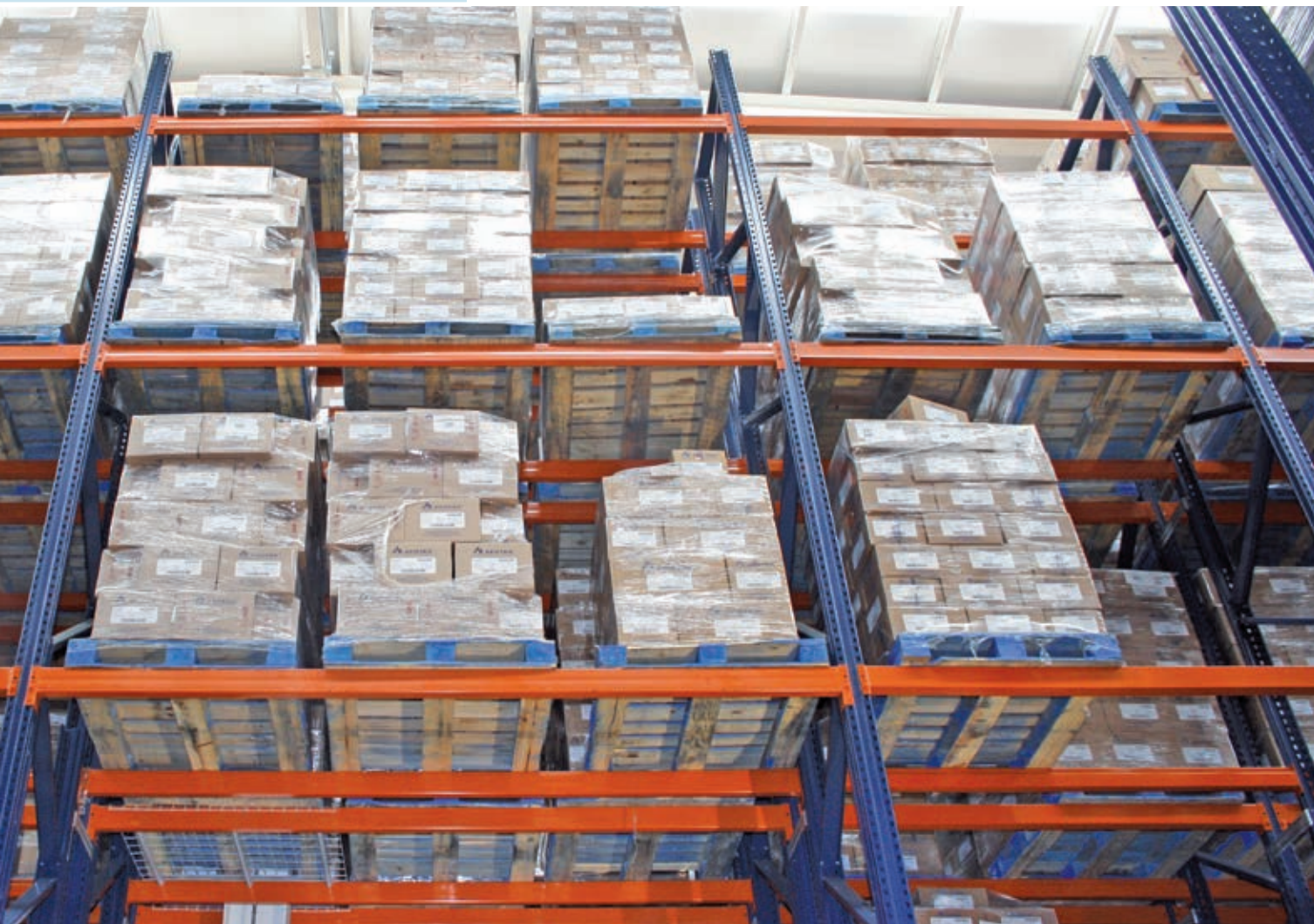
Almacén de rack selectivo. Tarima manipulada por el lado de 1016 mm.
