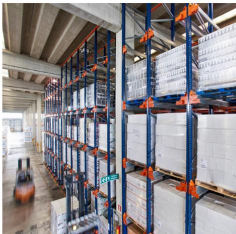
Teniendo esto en cuenta, Mecalux ha equipado el almacén con cuatro bloques de estanterías compactas con el sistema Pallet Shuttle semiautomático.
