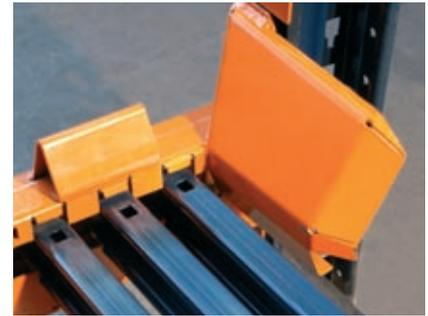
Las vigas delanteras disponen de apoyo y fijación, así como de topes y taladros, que hacen que sobresalga un testigo de presencia de carro disponible, necesario principalmente en los niveles elevados.
