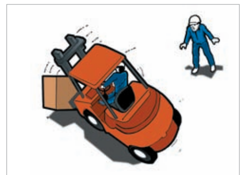
Figura 8 Pérdida del control del montacargas.
