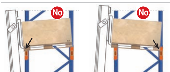
Figura 9 Sobrecarga sobre una viga por descenso no horizontal.
